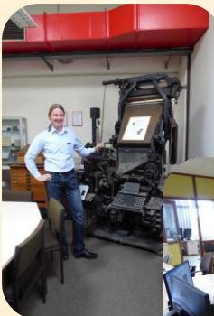
Herr de Groot vor der ersten Setzmaschine, die es ermöglichte, dass die einzelnen Typen (Buchstaben) automatisch wieder zurückgeführt werden konnten (Sie mussten also nicht mehr von Hand wieder in die Setzkisten sortiert werden).
